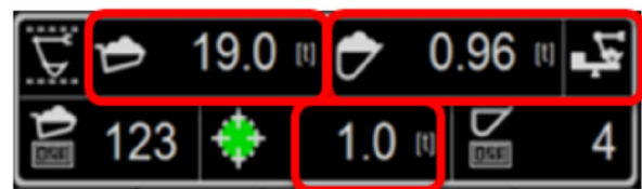
Ilustración 169 g06017881 Estado del pesaje: carga útil calculada Carga útil del cucharón: 1,96 t -> 0,96 t (calculada) Carga útil del camión: 18,0 t + 1,0 t = 19,0 t (calculada) Carga útil restante: 2,0 t - 1,0 t = 1,0 t (calculada)
