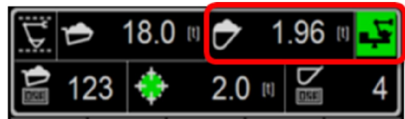
Ilustración 168 g06017842 Carga útil del cucharón: 1,96 t (a escala) Estado del pesaje: carga útil a escala obtenida
