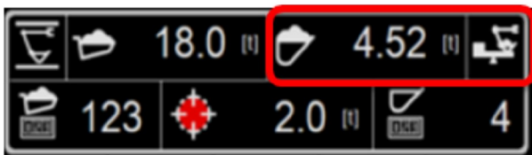
Ilustración 165 g06017820 Carga útil del cucharón: 4,52 t (calculada) Estado del pesaje: carga útil calculada
