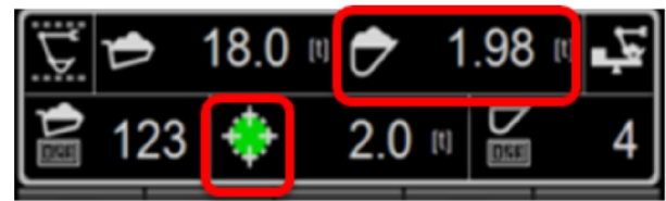
Ilustración 167 g06017840 Carga útil del cucharón de 1,98 t (calculada) Carga útil del cucharón de 1,98 t < Carga útil restante de 2,00 t Estado del camión: objetivo alcanzado
