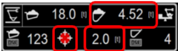
Ilustración 166 g06017822 Carga útil del cucharón de 4,52 t (calculada) > carga útil restante de 2,00 t Estado del camión: sobrecarga
